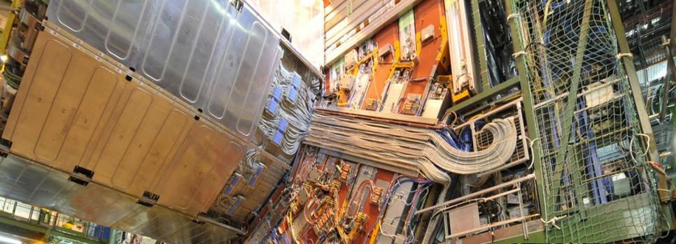
Naturalmente ogni componente ha la sua elettronica di lettura, elaborazione, controllo; piu' il raffreddamento, i gas, etc...
